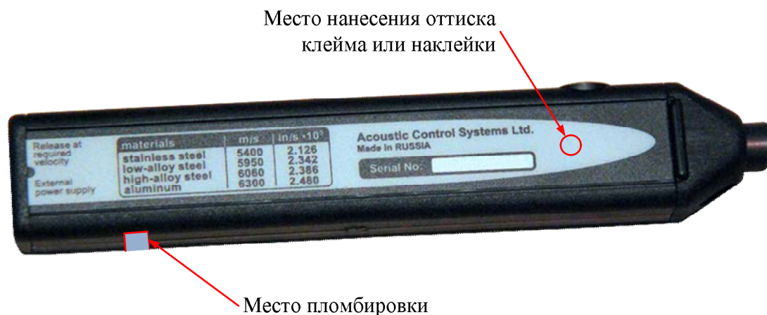
Рисунок 2 – Место пломбировки корпуса толщиномера и место нанесения оттиска клейма или наклейки
