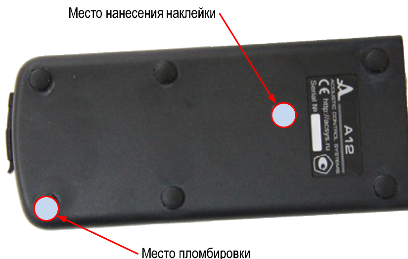
Рисунок 2 – Место пломбировки корпуса толщиномера и место нанесения наклейки
