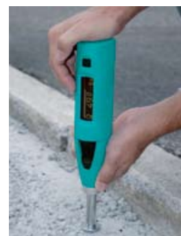
... на легком бетоне (с грибовидным плунжером)
